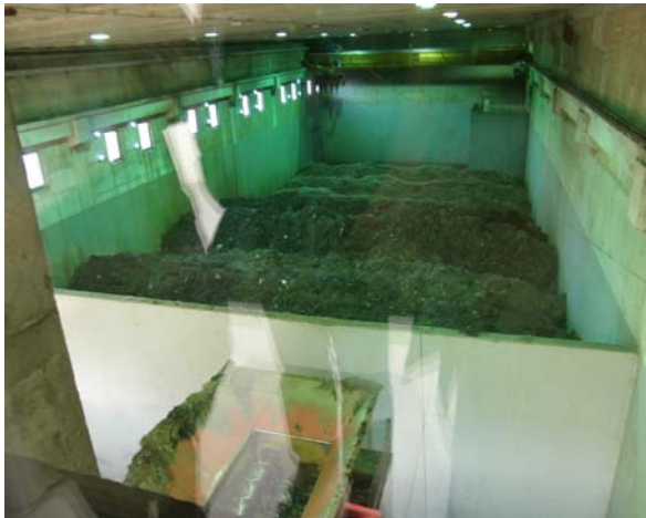
Слика 84 - Изглед постројења за МБО у Цељу, Словенија - капацитет 350.000 ЕС (горе). унутрашњост коморе за обраду отпада (доле лево) и филтери за пречишћавање ваздуха (доле десно)
