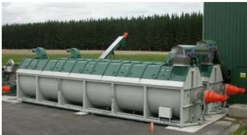
Слика 82 - Изглед хоризонталног реактора
