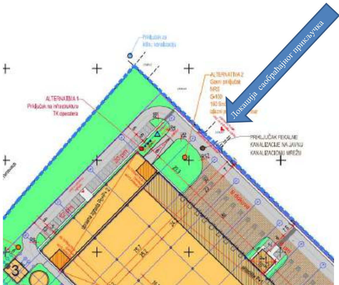
Слика бр. 4 Идејно решење планираног саобраћајног прикључка на на кп 1538/17 ко Крагујевац 1
